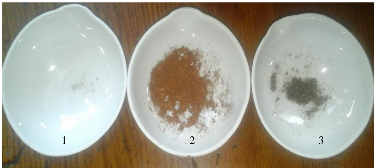
Рис. 58. Фотографії порошків після озолування: 1 – фітосорбент, 2 – фітосорбент з сорбованим Au; 3 – фітосорбент з сорбованим Pd
